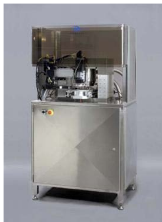
写真 Obducat社製ナノインプリント装置
